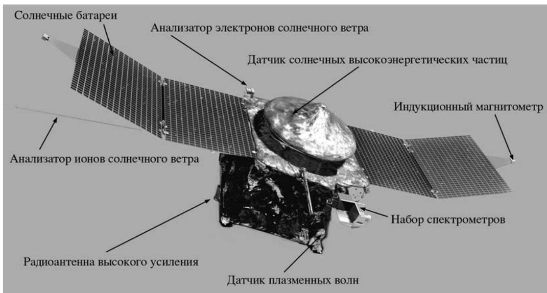
*Размещение научного оборудования и бортовых систем на АМС "MAVEN". Рисунок NASA/JPL.*
